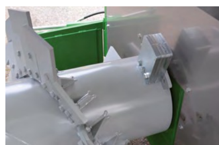
Épaisseur de raquette de 12 mm avec 3 vis de fixation. L'arbre équilibré assure une longue durée de vie.
