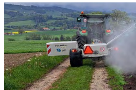
Grâce au poids pivotant, il est également possible de rouler dans une prairie. De plus, il assure une répartition optimale du poids et réduit le poids total de la machine d'environ 1'500 kg.
