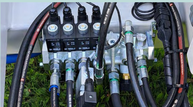
Panneau de commande pour vanne de sélection Les fonctions sont commandées par un pupitre de commande
