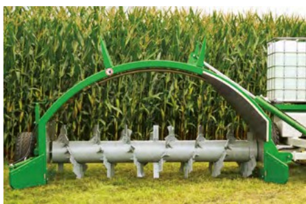
La construction massive en arc en acier de 6 mm assure une très grande stabilité.
