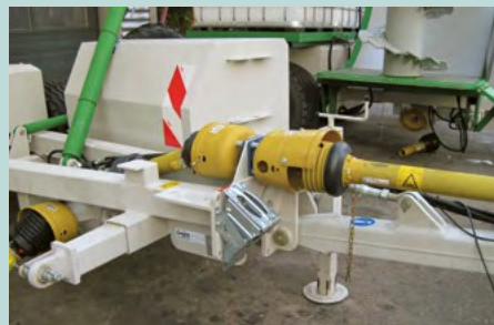
Attelage inférieur pour traction basse pour Hitch avec Piton ou K80.
