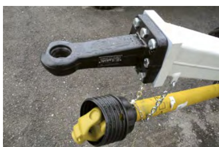
Attelage de remorque standard à l'avant : barre d'attelage DIN et barre d'attelage haute
