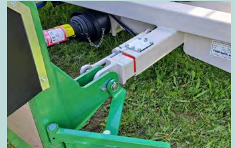
Déport latéral hydraulique pour que la Le loyer reste à sa place.
