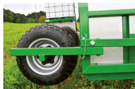
Pour le transport, la roue de jauge peut pivoter, pas de démontage nécessaire.
