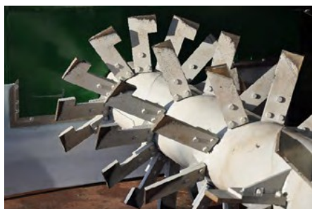
Une bonne vague de transvasement travaille le matériau de l'intérieur vers l'extérieur. Grâce à un brassage doux, les micro-organismes peuvent se multiplier partout de manière optimale.
