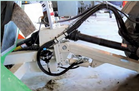
Timon articulé hydraulique - à partir du tracteur avec bloc de blocage (photo : traction basse avec amortisseur d'oscillations)
