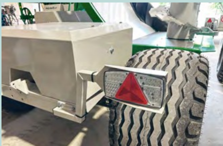
Système d'éclairage LED
