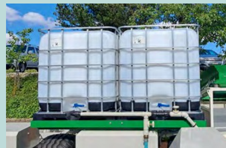
Cadre d'abreuvement double pour 2'000 litres
