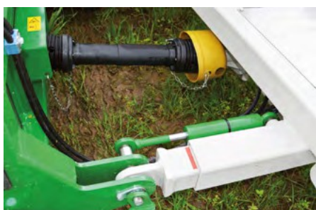
Entraînement direct - réducteur sur arbre de transfert
