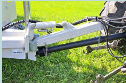
Timon articulé hydraulique - attelage par le haut
