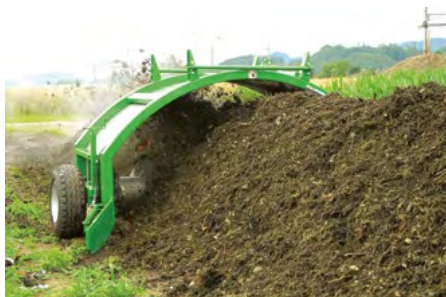
Taille maximale des tas : 3 x 1,5 m, afin de permettre le compostage aérobie.
