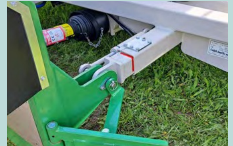
Desplazamiento lateral hidráulico, para que el La renta se queda donde debe estar.
