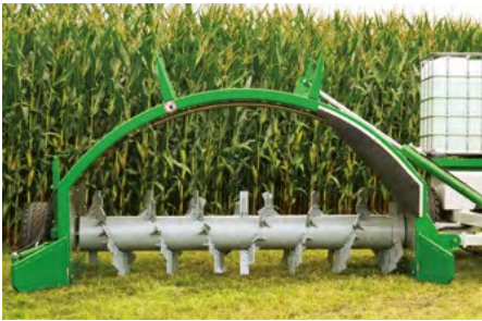
La sólida construcción del arco, de acero de 6 mm, garantiza una gran estabilidad.
