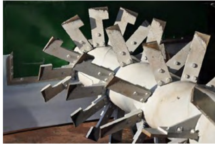
Una buena onda de volteo trabaja el material desde dentro hacia fuera. El volteo suave permite que los microorganismos se multipliquen de forma óptima por todas partes.
