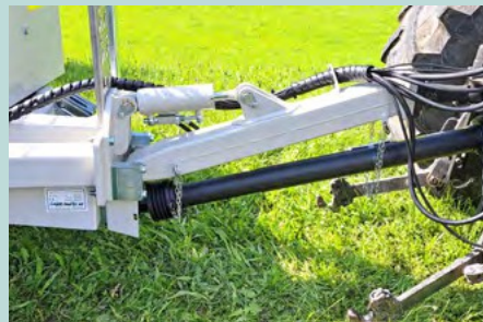
Lanza articulada hidráulica - enganche superior
