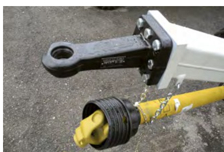
Gancho de remolque delantero de serie: DIN y gancho de remolque de tiro alto
