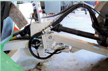
Lanza articulada hidráulica - desde el tractor con bloqueo (imagen: lanza baja con amortiguador de oscilaciones)
