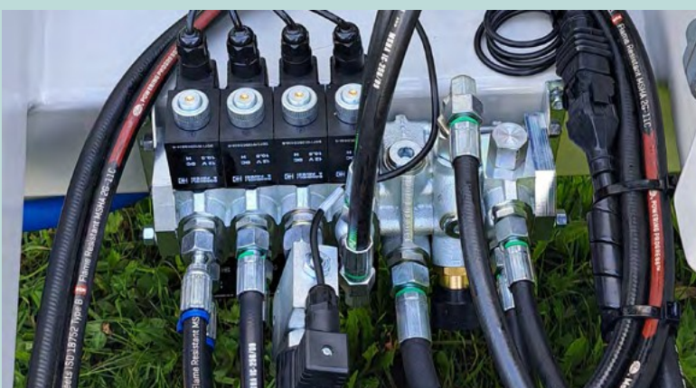
Panel de control de la válvula de selección Las funciones se manejan a través del panel de control
