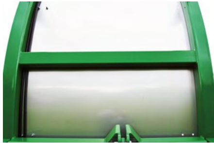
Todas las placas de desgaste son de acero al cromo.
