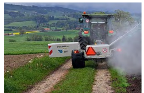
Gracias al peso basculante, también es posible por un prado. Además, garantiza una distribución óptima del peso y reduce el peso total de la máquina en unos 1.500 kg.
