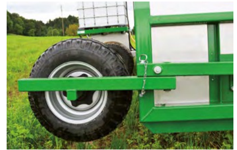
La rueda jockey puede girar para transportarla, sin necesidad de desmontarla.
