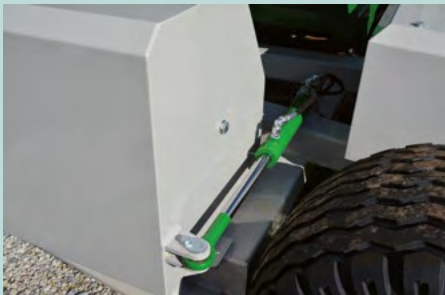
Contrapeso lateral giratorio hidráulicamente
