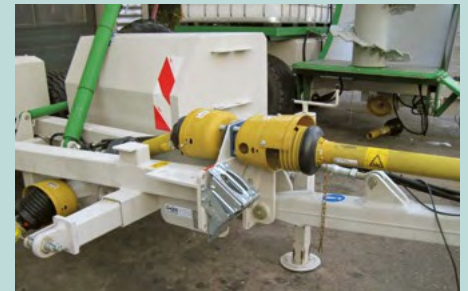
Enganche inferior para lanza baja para enganche con Pitón o K80.
