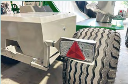
Sistema de iluminación LED
