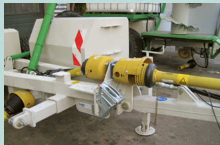
Untenanhängung für Tiefzug für Hitch mit Piton oder K80.
