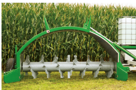
Die massive Bogenkonstruktion aus 6 mm Stahl sorgt für eine sehr grosse Stabilität.
