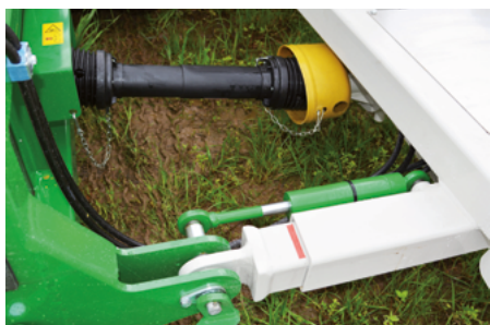
Direkter Antrieb – Getriebe auf Umsetzwelle
