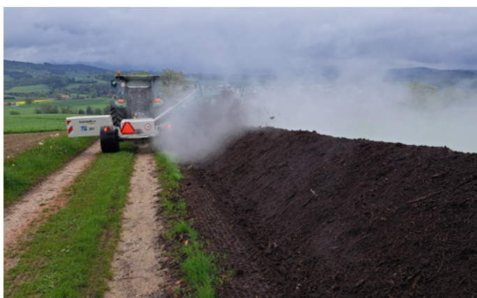
Schwenkbares Seitengewicht, schont Feld- und Flurwege.
