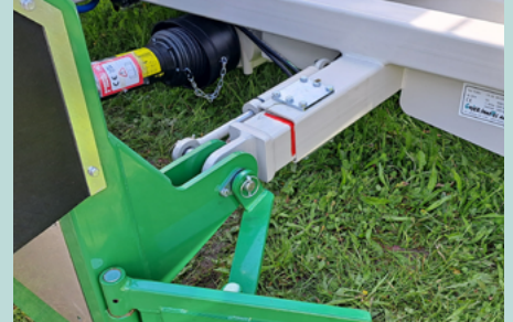
Hydraulischer Seitenversatz, damit die Miete da bleibt wo sie hingehört.
