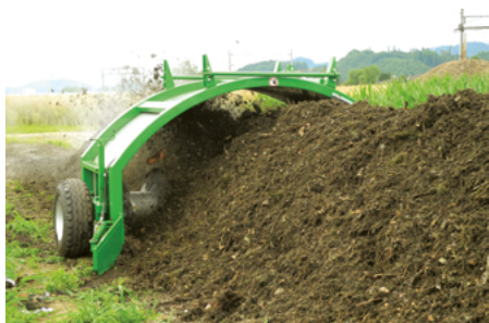
Maximale Mietengrösse: 3 x 1.5 m, damit aerob kompostiert werden kann.
