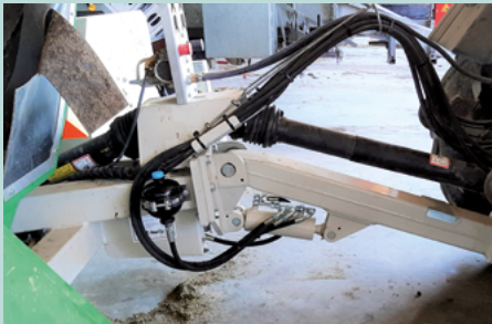
Hydraulische Knickdeichsel - ab Traktor mit Sperrblock (Bild: Tiefzug mit Schwingungsdämpfer)
