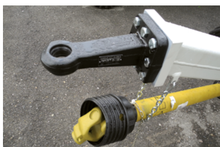
Standard-Anhängerkupplung vorne: DIN- und Hochzug-Deichsel
