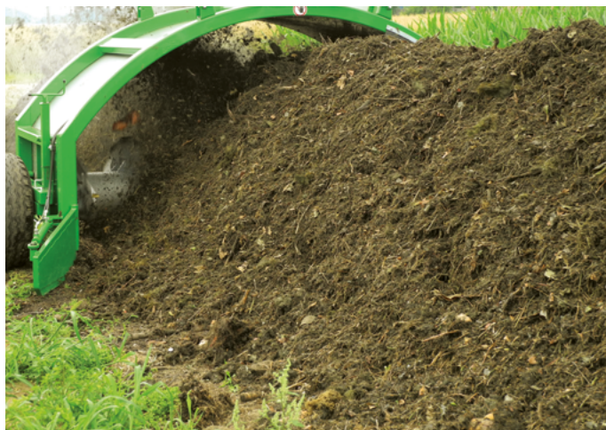
Mit der TG 301 gelingt das Kompostieren einfach und schnell. Dies liegt vor allem an der perfekt arbeitenden Umsetzwelle, die das Material von innen nach aussen fördert.
