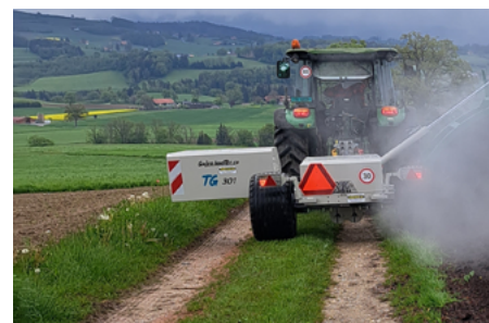
Dank dem Schwenkgewicht ist auch das Befahren einer Wiese möglich. Ausserdem sorgt es für eine optimale Gewichtsverteilung und verringert das Gesamtgewicht der Maschine um ca. 1'500 kg.
